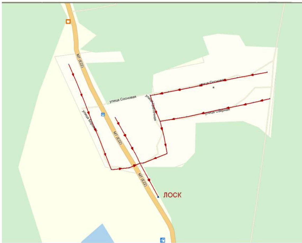
Рисунок 69 - Предлагаемая сеть централизованной системы канализации мкр. Сосновый .
