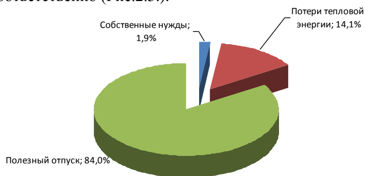
Рис. 2.5. Тепловой баланс котельной БСУСО УР «Канифольный ДДИ» (данные ТСО)
