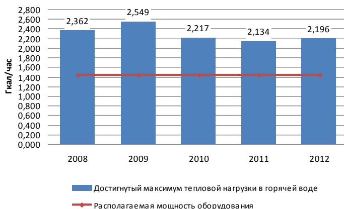
Рис.2.15. Достигнутый максимум тепловой нагрузки котельной ЛОК «Заря» в отопительный период
