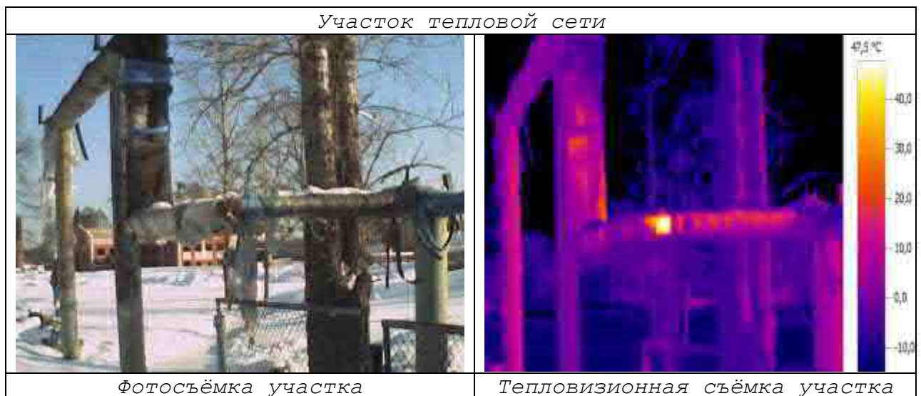
Рис.2.11. Результаты тепловизионной съемки тепловых сетей от центральной котельной РДС «Сельчка»
